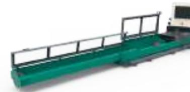
Mobile Zugprüfmaschine ZP20
