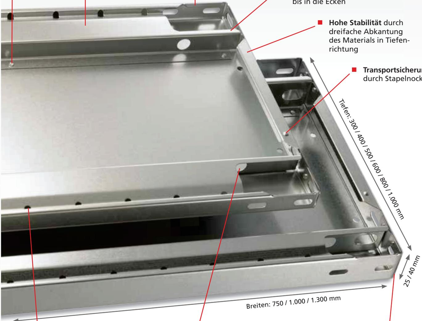
■ **Systemlochung** zum leichten Anbringen von Zubehör wie zum Beispiel Stecktrennbleche oder Draht-Steckgitter. Abstand der Systemlochung: 50 mm
